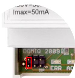
Rys 4.1: Montaż zworki na złączu ISP
